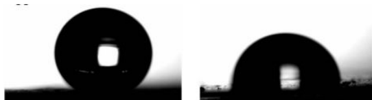
Figur 4: til venstre dråpe på hydrofobisk material SHS, til høgre dråpe på ubehandla aluminium Ruan et al. (2017)
